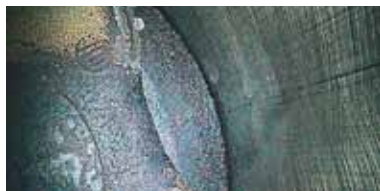
Endoscopisch onderzoek toont geen slijtage in het binnenwerk van de motor. Amper afzettingen aan de zuigers (l) en schone kleppen (r).
